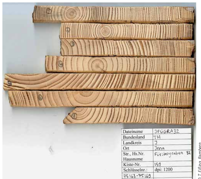
Abb. 7: Für die dendrochronologische Datierung aufbereitete Bohrkerne der erstverwendeten Konstruktionshölzer
