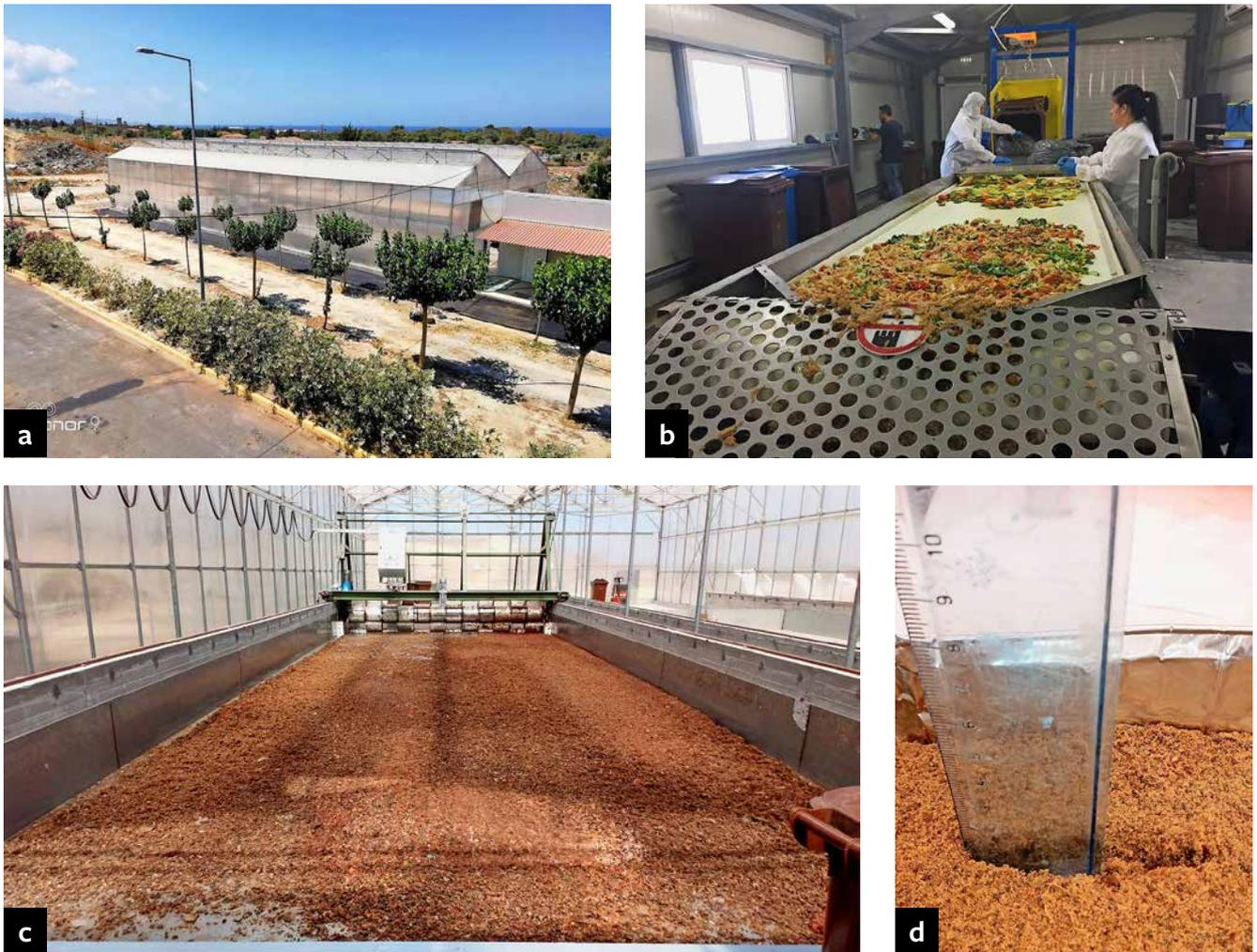
Abb. 1: Die „Pilot Unit“ in Heraklion (A), in der die gesammelten Speisereste sortiert (B), zerkleinert und mittels Solarenergie getrocknet wurden (C). Am Ende lagen die Speisereste mit einer Partikelgröße < 5 mm vor (D). Die getrockneten Speisereste wurden in die Rationen für die sich anschließenden Fütterungsstudien eingemischt.
