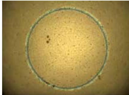
Abb. 1: Die Schalenperforation kann präzise und berührungsfrei mit einem CO 2 -Laser in die Eischale eingebracht werden. Dadurch lässt sich eine Sollbruchstelle schaffen, wobei ein dünner Steg der Kalkschale erhalten bleibt (im Bild unten links).
