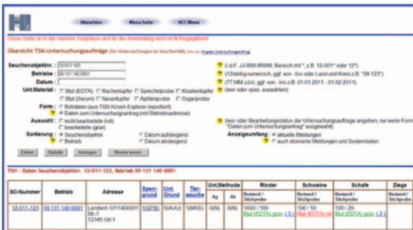
Abb. 5: Übersicht der aus TSN importierten Daten für die Erstellung von Untersuchungsaufträgen in HIT – durch die farbliche Kennzeichnung können bereits erstellte (grün) von noch zu bearbeitenden Aufträgen (rot) unterschieden werden.
